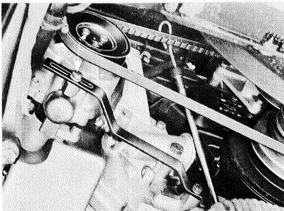
4. Desserrer la vis TH de la génératrice. Basculer la génératrice vers l'intérieur (si nec., déposer son capot de ventilation) et enlever la courroie.
