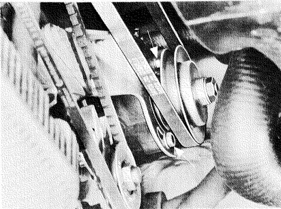
3. Desserrer la vis TH sur la pompe à air additionnel. Basculer la pompe vers l'intérieur et enlever la courroie.
