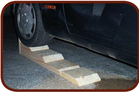
Un bricolage simple, en bois, permettant de surélever l'avant de la 928 et ainsi permettre d'accéder sous le moteur pour, par exemple, faire la vidange.
