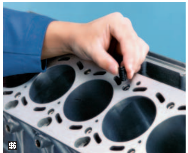
Photo 17 Poser la douille à la main et la visser quelques tours.
