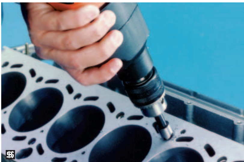
Photo 14 Chanfreiner le bord de l'avant-trou (profondeur 2,5 mm).
