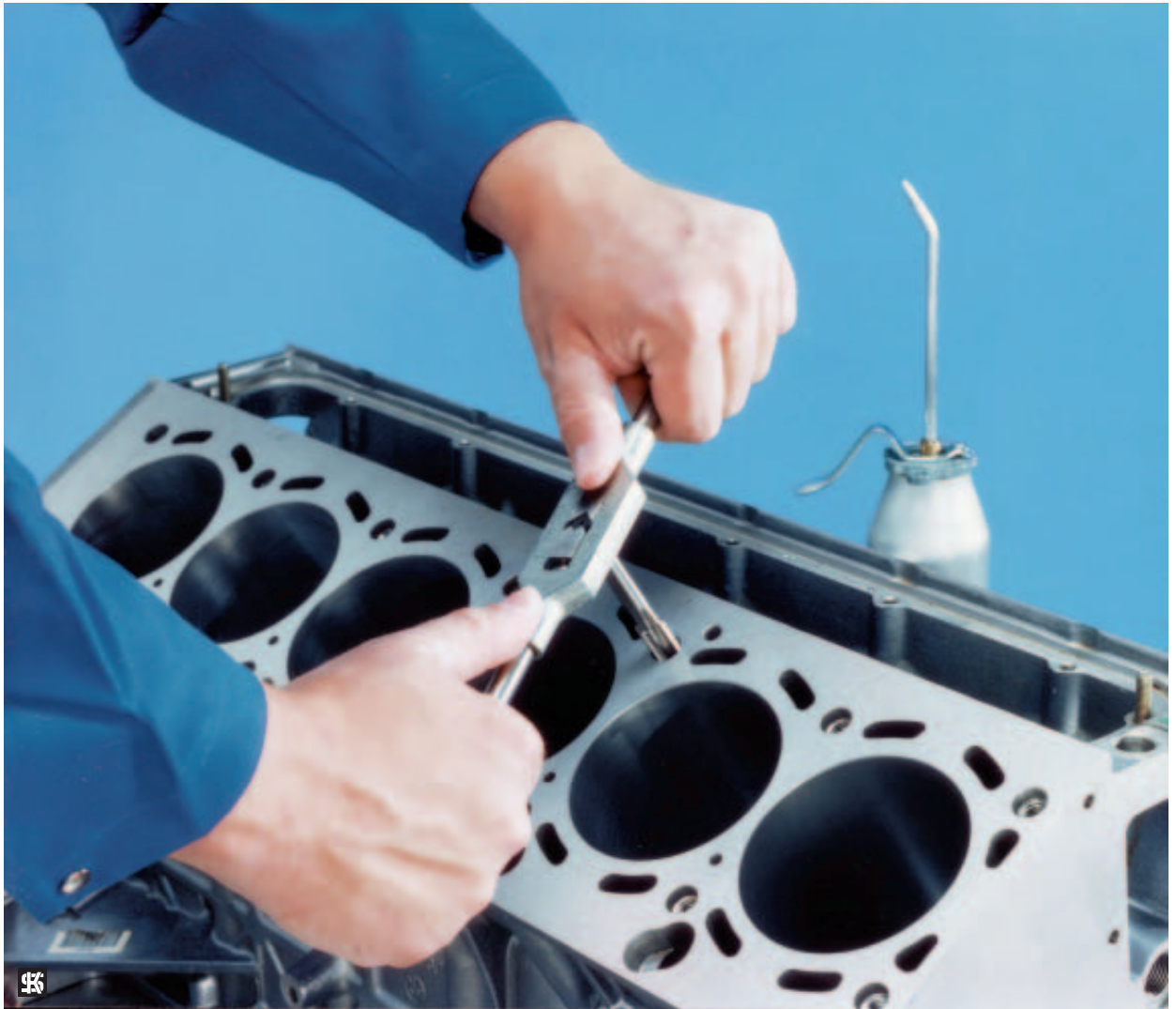
Photo 15 L'opération se fait avec un taraud.
