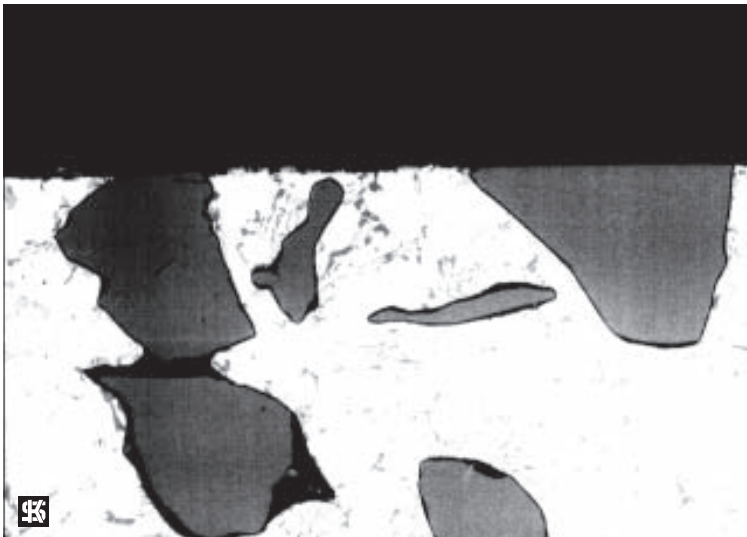
Dégagement des cristaux de silicium (grossissement 500)
