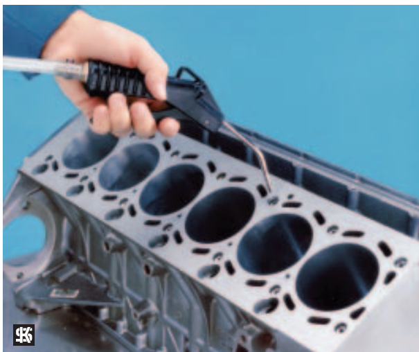
Photo 16 Important : Enlever les copeaux et l'huile à jet d'air.
