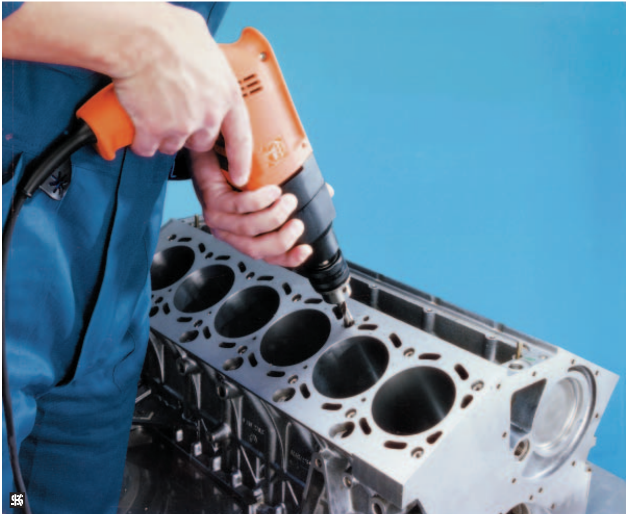
Photo 13 Percer un avant-trou ou évider l'ancien taraudage.
