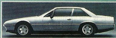
FERRARI 412 : 12 cylindres en V (2x2 ACT), 4 942 cm<sup>3</sup>, 34 CV fiscaux, 340 ch DIN, 1 805 kg, 250 km/h, 692 000 F en 1986.
