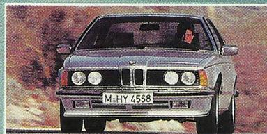
BMW M 635 CSI : 6 cylindres en ligne (2 ACT), 3 453 cm<sup>3</sup>, 20 CV fiscaux, 286 ch DIN, 1 500 kg, 255 km/h, 414 000 F en 1986.
