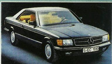
MERCEDES-BENZ 560 SEC : 8 cylindres en V (2x1 ACT), 5 547 cm<sup>3</sup>, 40 CV fiscaux, 300 ch DIN, 1 750 kg, 250 km/h, 593 640 F en 1986.
