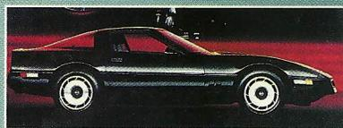
CHEVROLET CORVETTE : 8 cylindres en V, 5 733 cm<sup>3</sup>, 33 CV fiscaux, 233 ch, 1 415 kg, 230 km/h, environ 320 000 F en 1986.
