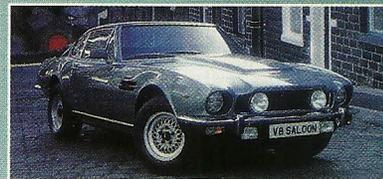
ASTON MARTIN V8 : 8 cylindres en V (2x2 ACT), 5 340 cm<sup>3</sup>, 34 CV fiscaux, 309 ch DIN, 1 727 kg, 235 km/h, 856 000 F en 1986.
