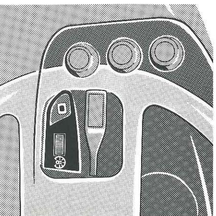
En tournant le bouton moleté, l'intensité de l'éclairage des instruments peut être réglée progressivement.
