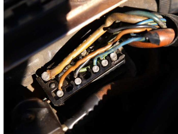
*Fig 3: le connecteur T14 sous le capot moteur (couvercle enlevé)*
