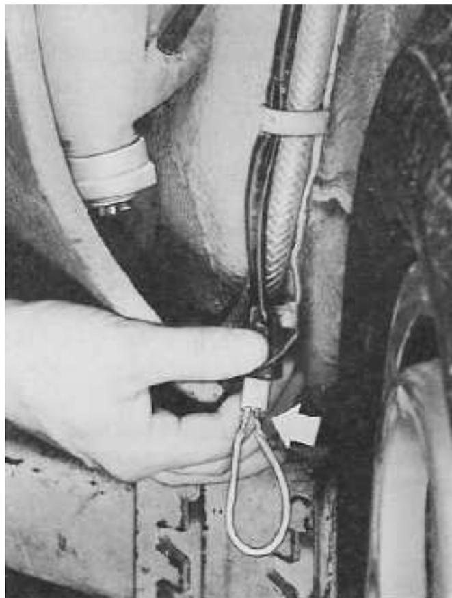
Le capteur se trouve dans le passage de roue avant droit, en dessous de la plaque de couverture. Débrancher le connecteur et ponter les contacts.
